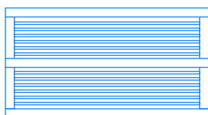
Одиночная решетка, H \geq 225 мм, с горизонтальной центральной стойкой
