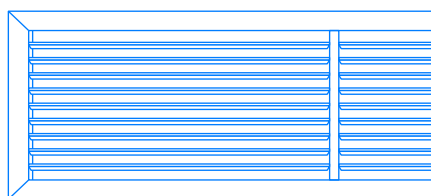
Одиночная решетка, L \geq 625 мм, с центральной стойкой
